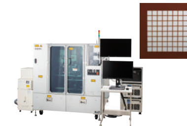
レーザ微細加工装置 ポリアミドイミド格子加工
