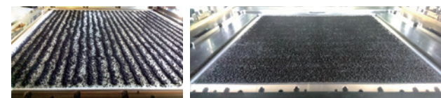
左：不適切な樹脂供給 右：高品質な樹脂供給
