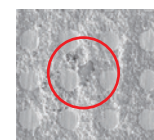
チップと基板の隙間への樹脂充填（MUF）において真空引き不良により生じる欠陥（ボイド）の観察例
