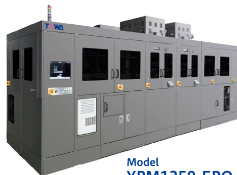
生成AI向け、高性能AIパッケージ(チップレット製品)に対応したトランスファ成形装置
