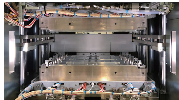
次世代パッケージング用モールドング金型・プレス
