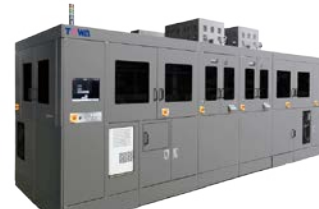
2.5D/3D/チップレット製品に最適な トランスファモルディング装置 Model YPM1250-EPQ
