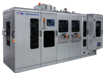
▲PMC 次世代半導体の量産に最適なモジュール方式を採用。コンプレッションモールド方式により廃棄物の削減など環境にも配慮しています。
